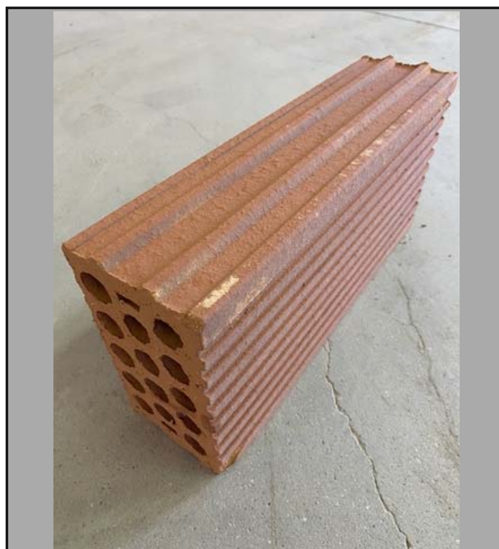
Fotografía 1: Imagen de una de las piezas de arcilla cocida ensayadas
